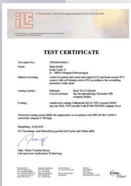
La estructura de recubrimiento probada (el apoyo STA F de siFramo y el perfil de montaje TP F conectados con el tornillo autorroscante FLS F) cumple los requisitos de la normativa DIN EN ISO 12944-6 Categoría de corrosividad C5M-alta.
